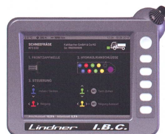
Le terminal «IBC» affiche à l'intention du conducteur les raccords hydrauliques et les distributeurs corrects à utiliser, ainsi que le régime approprié de prise de force.
