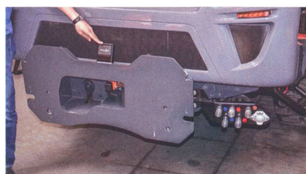
Dès qu'un outil est installé, il est reconnu par le système «TracLink», qui affiche immédiatement ses caractéristiques.
