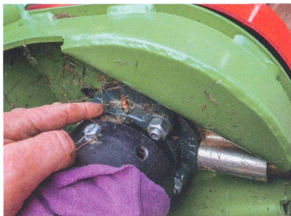
La tension des courroies est réglable de l'extérieur, mais il est quand même nécessaire de retirer le cache.
