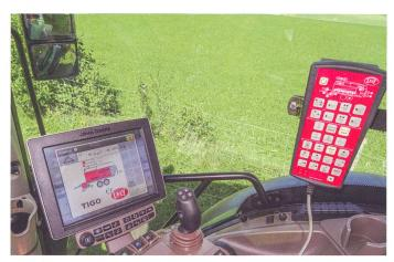
La machine est commandée soit par le terminal du tracteur, soit par l'ordinateur fourni par Lely. Une combinaison des deux systèmes est possible.
