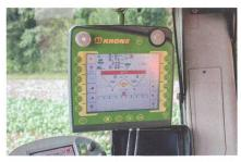
Isobus permet d'agir sur l'épandeur soit par le terminal du tracteur, soit via un autre terminal déjà présent sur l'exploitation. Amazone propose aussi son propre terminal Isobus.
