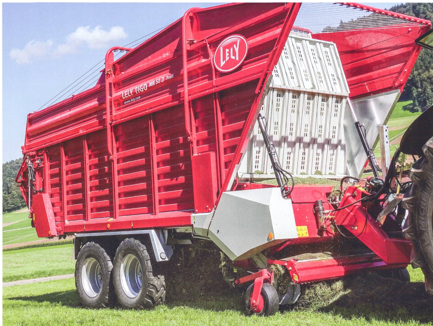
Une classe moyenne avec les caractéristiques des grandes: la Lely «Tigo MR 50» en version «Profi» (avec paroi frontale inclinable) et deux rouleaux démêleurs («D»). Photos: Roman Engeler
