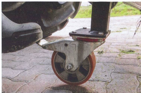
Pour le rangement après usage, la machine possède une petite roue d'appui escamotable, munie d'un frein.
