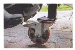
Pour le rangement après usage, la machine possède une petite roue d'appui
