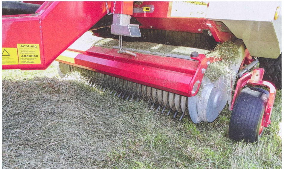
Le pick-up de 180 cm comprend cinq rangées de dents. Il est entraîné par des chaînes et protégé des surcharges par un embrayage.
