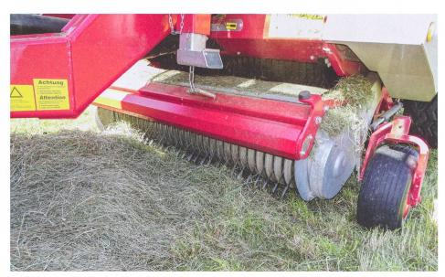
Le pick-up de 180 cm comprend cinq rangées de dents. Il est entraîné par des chaînes et protégé des surcharges par un embrayage.
