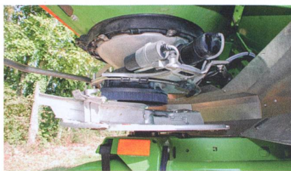
Le point de chute et l'ouverture de la trémie sont réglés électriquement.
