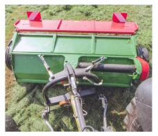
La tête d'attelage dispose d'un important pivotement latéral. Deux amortisseurs assurent un verrouillage en douceur au relevage de la machine.
