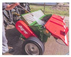
Le capot et la tôle de conditionnement associée peuvent être basculés vers l'avant, sans besoin d'outil, pour procéder à un nettoyage ou à des travaux d'entretien.
