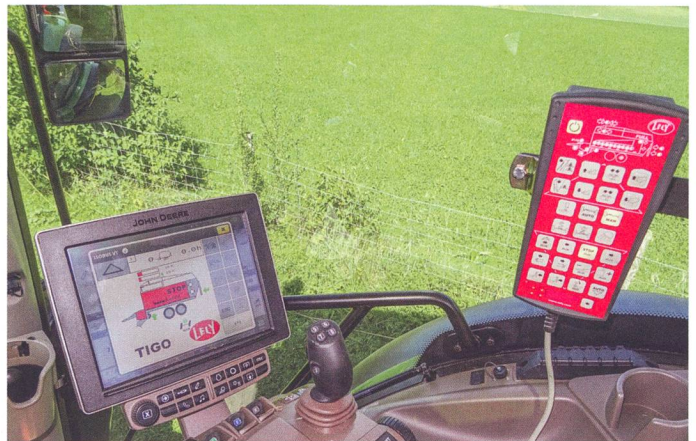
La machine est commandée soit par le terminal du tracteur, soit par l'ordinateur fourni par Lely. Une combinaison des deux systèmes est possible.
