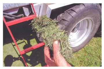
Coupe nette: avec ses 31 couteaux placés entre les doigts du rotor, la longueur de coupe théorique est de 45 mm.
