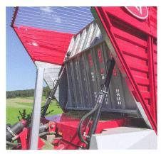
La paroi frontale multifonction peut s'incliner de 80°, apporte 6 m³ de capacité de chargement supplémentaire et participe au chargement et au déchargement.
