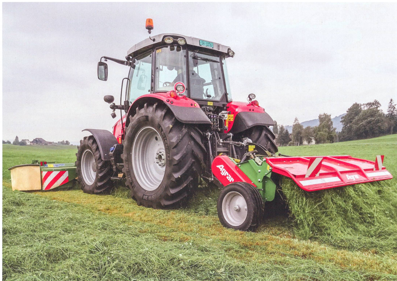
La conditionneuse Agrar «IC 20» a été testée en association avec une faucheuse frontale Krone «EasyCut 360» et un tracteur «MD 5613».
