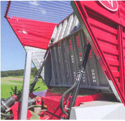
La paroi frontale multifonction peut s'incliner de 80°, apporte 6 m 3 de capacité de chargement supplémentaire et participe au chargement et au déchargement.
