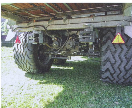
L'essieu suiveur proposé en option est commandé par Isobus et alimenté par un circuit Load Sensing selon la vitesse d'avancement et automatiquement verrouillé en marche arrière.
