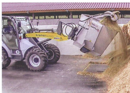
Cet outil de Sieplo transforme un chargeur en remorque désileuse-mélangeuse-distributrice grâce à sa fraise de désilage et à sa vis de mélange verticale.
