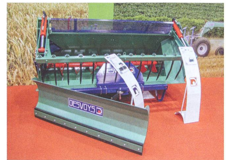
Le godet désileur et distributeur de Desvoys peut être attelé rapidement à un pousse-fourrage.
