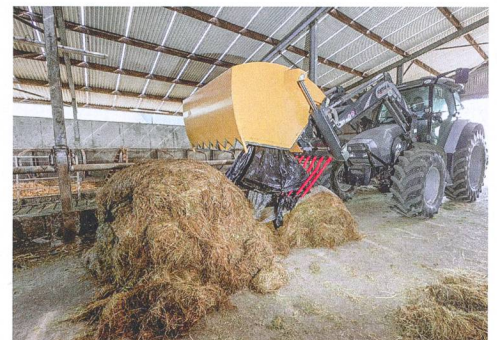
La pince « 175 Multi Shear » de Tanco peut prendre en charge les balles rondes. Elle est équipée d'un dispositif de retenue du film plastique.
