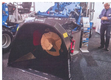
Quapppen propose des bols mélangeurs équipés de vis verticales à couteaux de différentes tailles.
