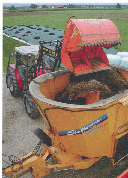
Cet outil réunit les avantages de l'étanchéité d'un godet avec ceux d'une pince à désiler.
