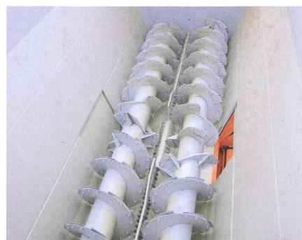
**Les remorques mélangeuses horizontales disposent d'une à quatre vis de brassage. « Horizontal » se réfère au positionnement des vis.**
