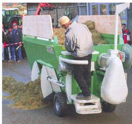
**Les exploitations petites ou moyennes, avec des passages étroits, se tournent souvent vers des petites automotrices entraînées par un moteur électrique ou thermique.**
