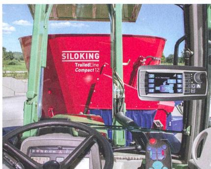
**Les remplisseurs externes doivent être alimentés par un chargeur. Une vision directe sur les indications de la balance constitue un grand avantage.**
