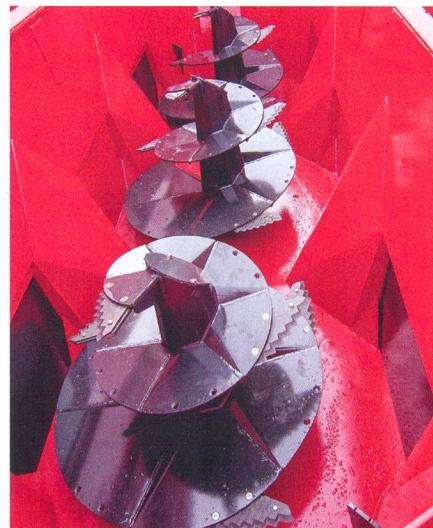
**Les remorques mélangeuses verticales disposent d'une à trois à 3 vis de brassage travaillant verticalement.**
