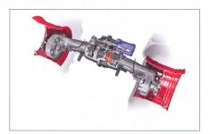
Nouveau pont avant avec blocage de différentiel, double moteur hydrostatique, frein de parking automatique et télégonflage.
