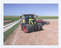
Avec « Turn In », Claas ajoute une nouvelle fonction qui dirige automatiquement la machine sur la meilleure ligne de guidage lors du demi-tour en fourrière. Dès que la machine se rapproche d'au moins 120° de la trajectoire, « Turn In » propose au conducteur une ligne de guidage pour se positionner sur le passage suivant. Le conducteur n'a plus qu'à activer le système de guidage pour réaliser parfaitement la reprise de ligne suivante.
