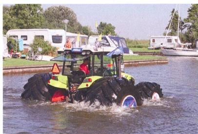
Grâce à des pneus Mitas à (très) gros volume, un Claas «Axos 320» de passé 4 tonnes a roulé sur l'eau. Sans ses pneus flottants, il aurait, on s'en
