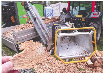
Le modèle « Effiter 20.30 » d'Alvatec produit des copeaux de bois fragmentés offrant des propriétés de séchage optimales.
