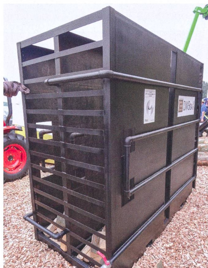
La box de séchage de Drywoodboxx GmbH est traversée par un circuit d'eau chaude. On économise ainsi le courant nécessaire à l'alimentation des ventilateurs.
