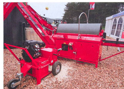
Ce groupe générateur équipe les combinés scie-fendeuse entraînés par une prise de force de la gamme « Hakki Pilke ».
