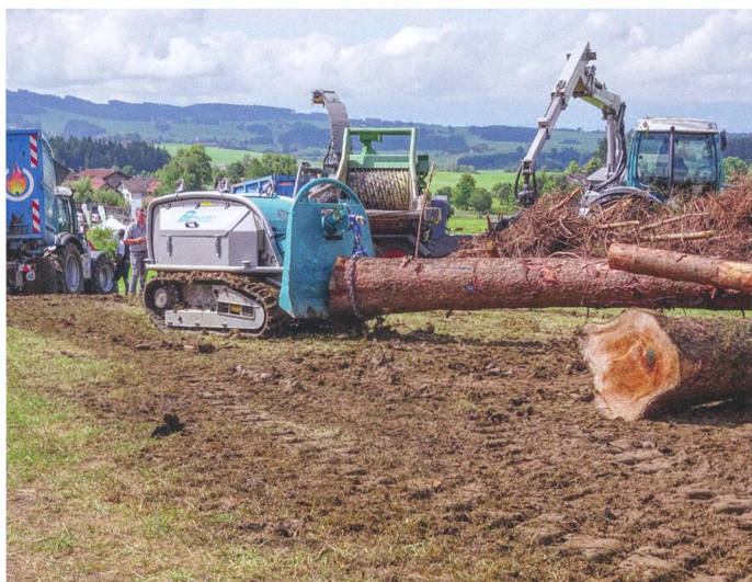
Le chenillard «Moritz» ne craint pas les terrains pentus et constitue une alternative aux tracteur et treuil dans les sols sensibles.
