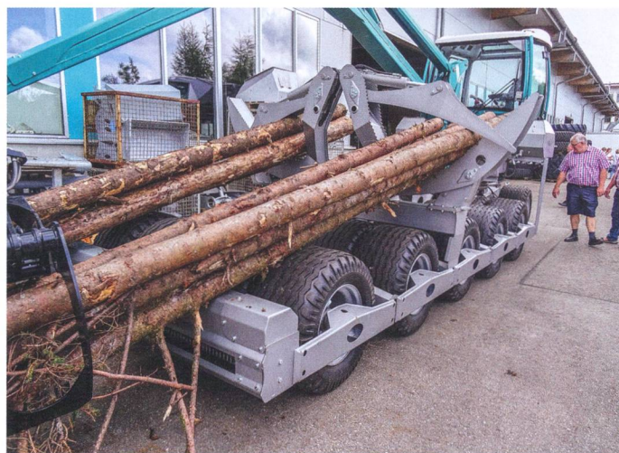
Ce prototype de débardeur à 22 roues pour terrains très humides n'a pas manqué d'attirer l'attention et suscité bien des questions.
