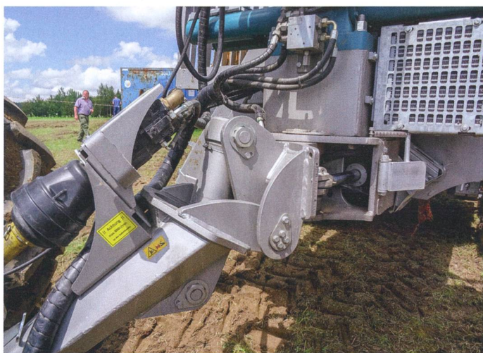
Pfanzelt a mis au point un système de timon articulé avec suspension qui permet de maintenir la remorque horizontale dans les dévers.
