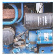
La vanne de raccordement supplémentaire avec fermeture en position médiane et la pompe hydraulique permettent au modèle Ford « 6610» de raccorder cette pompe supplémentaire et de doubler le débit initial de 35 litres par minute.
