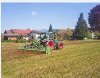
est mulchée, ce qui rend un nouveau travail du sol avant le semis inutile. Les fraises peuvent également être utilisées simplement pour le mulching d'un engrais vert. Pour cela, le rotor sera équipé de lames en forme de C. Si elles sont équipées d'un attelage trois points, elles peuvent être combinées avec un semoir monograine ou un semoir en ligne.
