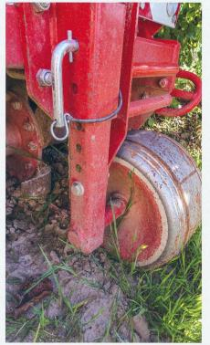
y compris les bandes étroites qui pourraient substituer en raison de la construction de la machine. Les lames en forme de L doivent travailler le sol en étant tirées. L'inclinaison du capot peut être réglée avec une goupille. Le matériel fraisé doit pouvoir être projeté à l'intérieur du capot, pour donner par la suite un lit de semence aéré. Ce dernier ne doit en aucun cas être roulé ou tassé, sinon tout l'effet du fraisage est perdu.
