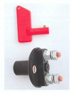
Le danger d'incendie du véhicule peut être réduit avec un nettoyage régulier et l'installation d'un commutateur de batterie bien accessible.
