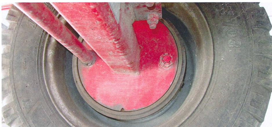
Avec la fenêtre de contrôle, on peut vérifier l'épaisseur de la garniture.
