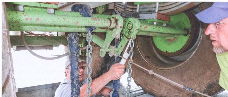
La longueur du levier de frein ne doit pas être modifiée.
