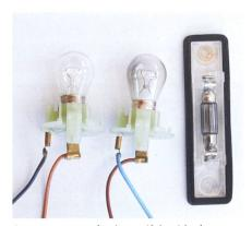
Avec un usage plus intensif, le vide des ampoules se modifie de l'intérieur et réduit le pouvoir éclairant.
