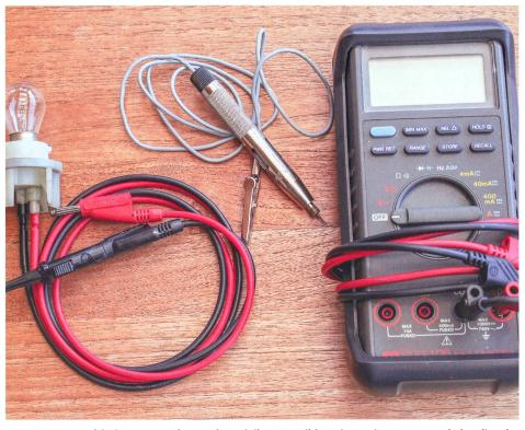
Avec un multimètre ou une lampe d'essai, il est possible – si on sait comment – de localiser la plupart des dérangements de l'installation électrique d'un véhicule.
