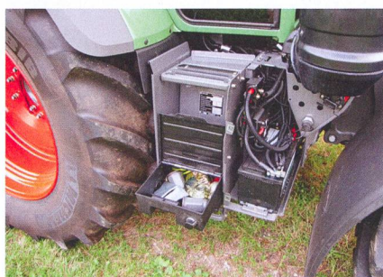
La batterie et la caisse d'outils sont bien atteignables sous les marches d'accès de la cabine à droite.
