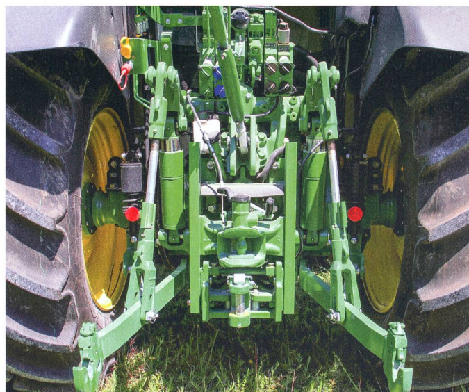
A l'arrière, le nouveau «5R» a une capacité de levage de 4,7 t, pouvant aller, en option, jusqu'à 5,3 t.
