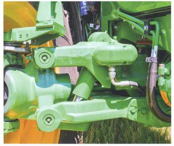
La suspension avant à roues indépendantes, développée par Carraro, peut être désactivée en cas de besoin, avec possibilité de réglage manuel de la hauteur.
