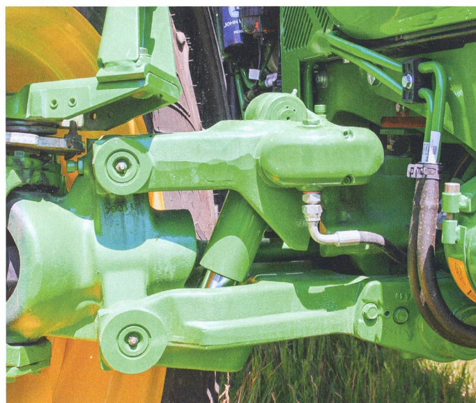
La suspension avant à roues indépendantes, développée par Carraro, peut être désactivée en cas de besoin, avec possibilité de réglage manuel de la hauteur.
