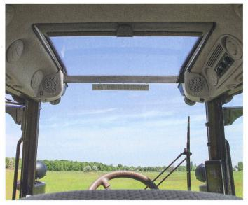
Le toit panoramique permet de suivre les mouvements du chargeur frontal en position haute.
