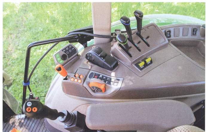
Le modèle d'entrée de gamme, avec distributeurs mécaniques et, pour la commande du chargeur frontal, un joystick mécanique attaché au siège du conducteur.
