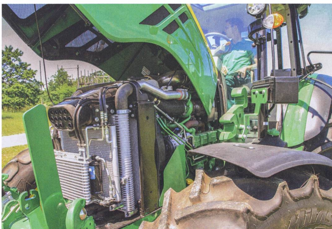
Le moteur 4 cylindres de John Deere remplit les critères de la Phase 3b en matière de gaz d'échappement et fonctionne au seul diesel.
