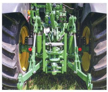
A l'arrière, le nouveau «5R» a une capacité de levage de 4,7t, pouvant aller, en option, jusqu'à 5,3t.
