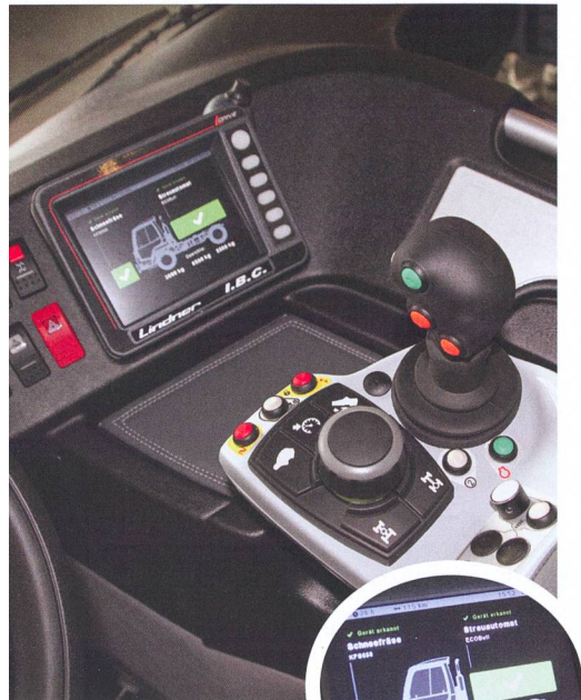
La desserte de l'entraînement à variation continue est identique à celle du «Lintrac». On retrouve dans l'«Unitrac 112 LDrive» le même accoudoir et le même terminal «IBC» pour des stratégies de conduite similaires (petite photo).
