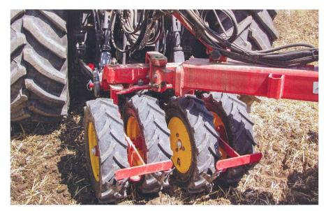
Avec l'option «Attelage de levage» et «pneumatiques de rappui», le point de rotation du timon est très en arrière, ce qui améliore la maœuvrabilité.
