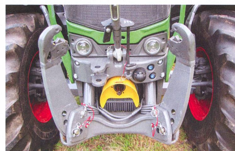
Le relevage frontal est intégré harmonieusement dans le demi-châssis taillé.
