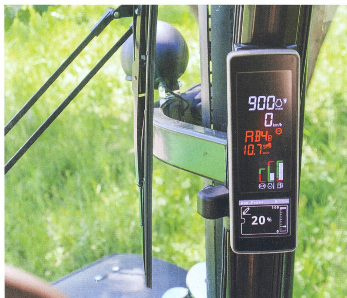
Les informations importantes sont visualisées sur l'afficheur incorporé dans la colonne d'angle. Le tableau de bord classique a disparu.
