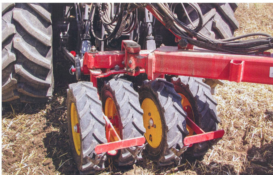
Avec l'option « Attelage de levage » et « pneumatiques de rappui », le point de rotation du timon est très en arrière, ce qui améliore la manœuvrabilité.
