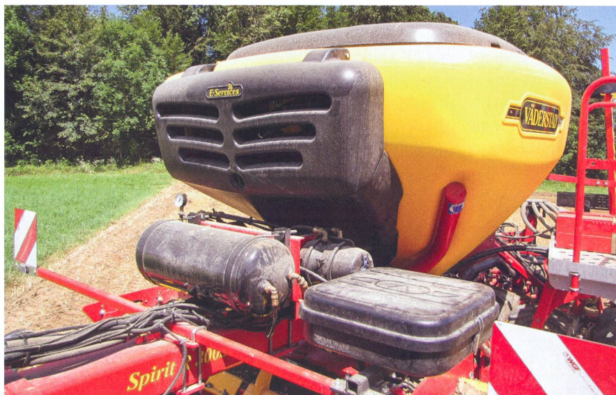
La ventilation est intégrée à l'avant de la trémie en plastique. Ainsi, l'aspiration de la poussière devrait être limitée et toutes les pièces du dispositif sont bien protégées.
