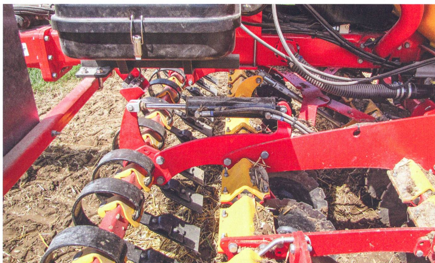
Les groupes d'outils herse à disques, « Crossboard », socs semeurs peuvent être réglés par un vérin hydraulique depuis la cabine.
