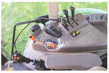
Le modèle d'entrée de gamme, avec distributeurs mécaniques et, pour la commande du chargeur frontal, un joystick mécanique attaché au siège du conducteur.
