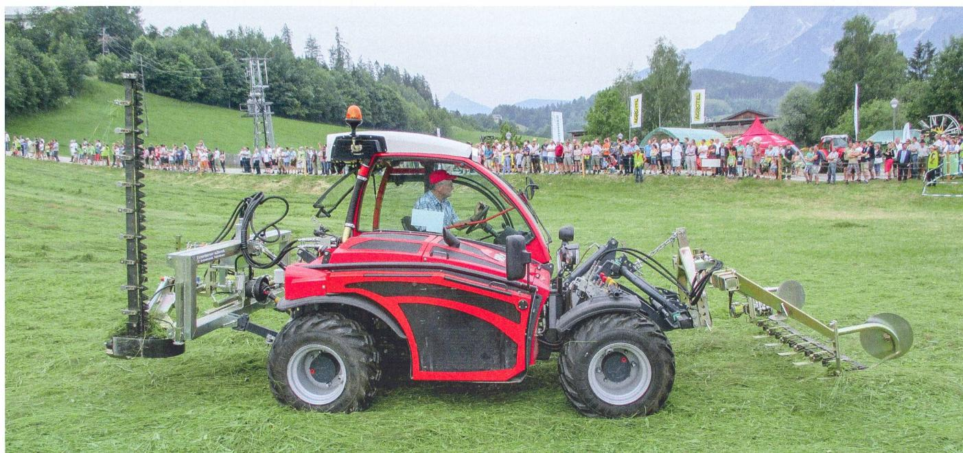
Avec 1,85 kW/m, une combinaison de fauche à double couteau dotée d'une largeur de travail de 10,25m a des besoins de puissance à la prise de force qui sont clairement inférieurs à ceux d'une combinaison de faucheuse à disques.
