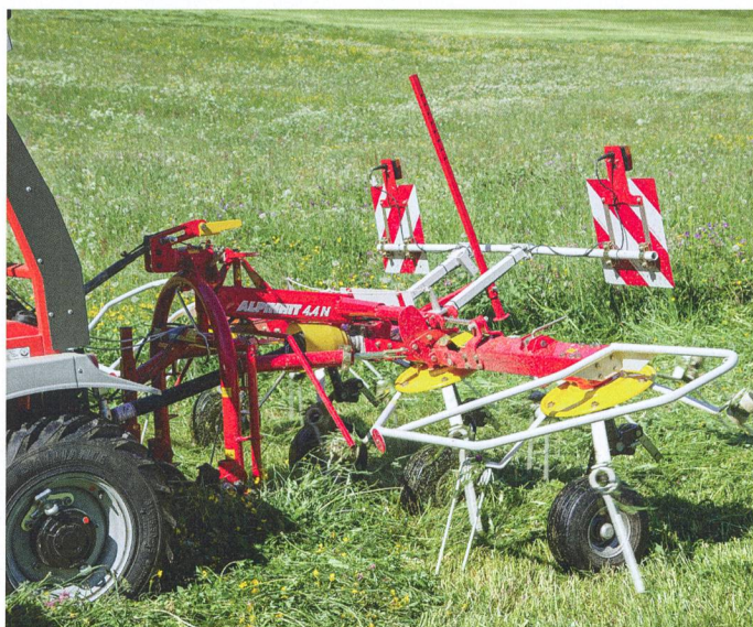
Arceaux de protection, signalisation et éclairage sont les éléments de sécurité principaux. Sur la photo: une « Alpinhit » de Pöttinger.
