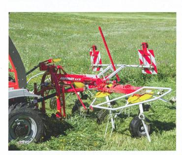
Arceaux de protection, signalisation et éclairage sont les éléments de sécurité principaux. Sur la photo: une « Alpinhit » de Pöttinger.
