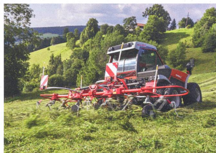
Les faneuses des régions de montagne doivent être courtes et compactes. Sur la photo: une Lely « Alpine ».
