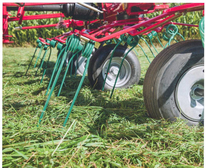
Plus les roues de gros volume sont proches de la trajectoire des dents, meilleure est l'adaptation au sol.
