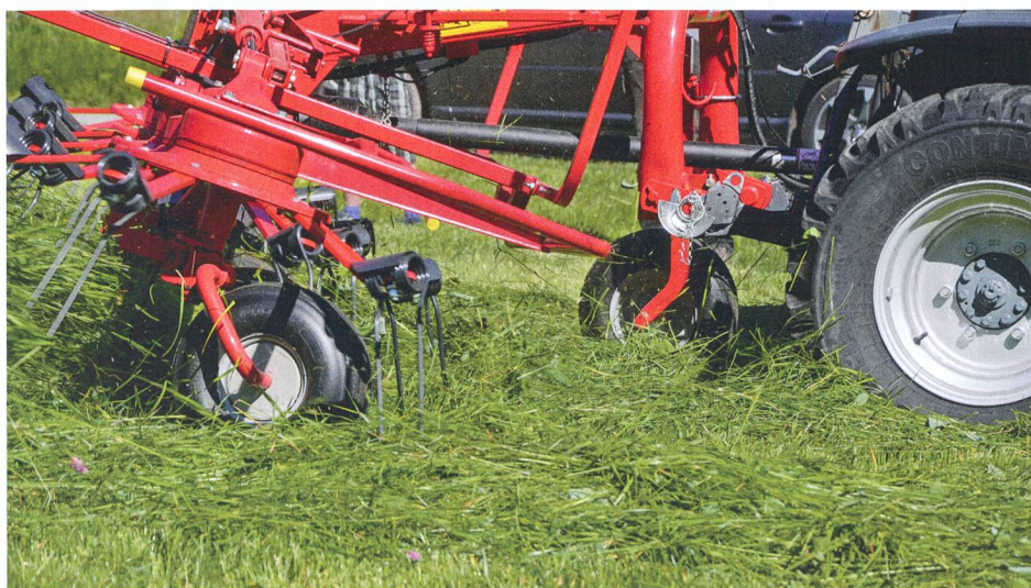
Le réglage du support des roues permet d'adapter l'angle de fanage du « Girofaneur » de Kuhn en fonction des particularités du fourrage.
