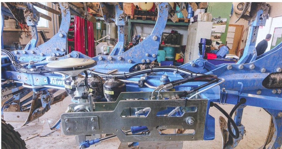
Le récepteur de la charrue doit être installé de manière à être protégé également lors du retournement.
