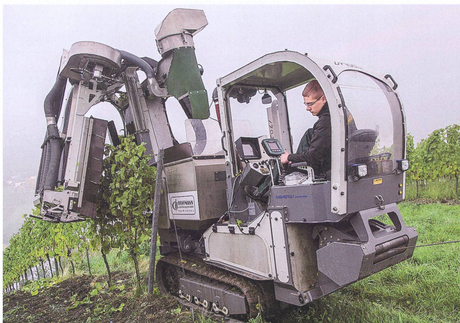
La vendangeuse sur chenillard développée par Carl Hoffman va procéder à sa première vendange commerciale. Photo : Eilbot.com
