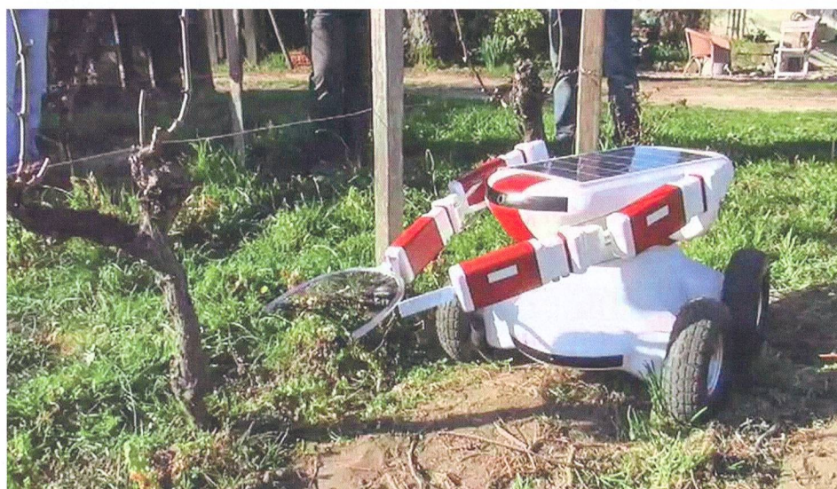
Le robot VIN devrait à terme être capable de réaliser la taille, l'épamprage, le liage et le comptage des pieds de vigne manquants. Photo: Wall-ye
