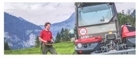
Aebi présente une nouvelle option pour le « Terratrac », la conduite autonome qui transforme ce véhicule en porte-outils autonome sans conducteur, grâce au GPS. Il planifie automatiquement ses trajectoires à l'intérieur de la zone d'intervention prédéfinie. Le « Terratrac » peut aussi être contrôlé à distance par radio. Il est alors en mesure de réaliser des travaux sur des espaces verts de toutes sortes, plats ou en déclivité.
