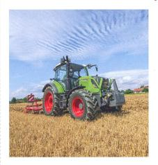
Fendt a actualisé ses tracteurs «500 Vario» de 125 à 165 chevaux. Mis à part la mise au niveau 4 des normes d'émissions des moteurs Deutz de 4,041 à recyclage des gaz d'échappement, réduction catalytique sélective (RCS) et filtre à particules, les quatre modèles «512», «513», «514» et «516» se voient dotés de cabines «VisioPlus» et peuvent être enrichis
