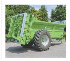
Joskin enrichit sa palette d'épandeurs à fumier avec le «Tornado 3 », de construction courte, au point que la longueur du caisson en acier «HLE 550 » ne dépasse pas 5 mètres jusqu' au fond poussant. Cela doit simplifier l'usage de la machine et la rendre particulièrement attractive dans les régions au foncier morcelé. Le centre de gravité, à 1,13 m du sol, est particulièrement bas, grâce au châssis ramassé et malgré un volume utile de 11 m³.
