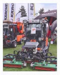
outil, utilisable dans les zones piétonnes, nécessite un permis de voiture. Avec 73 dB, mesurés en cabine, le bruit perçu par l'opérateur est relativement bas. Son empattement long lui permet de se déplacer confortablement, même à des vitesses élevées.
