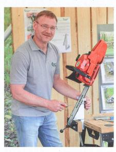
dans une position qui permet à l'opérateur tenant sa lime à l'horizontale de donner un angle précis de 30° aux maillons de la chaîne, en excluant quasi tout risque de suraffûtage ou d'affûtage insuffisant. Ce « Vert-i-file » coûte 49 euros. Il convient à toute tronçonneuse jusqu'à 6,5 kg et guide chaîne de 45 cm maximum.
