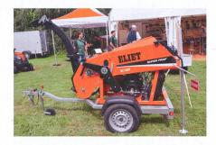
mité du canal d'alimentation. Quand la personne revient à sa place de travail, la machine redémarre automatiquement. Ce système maintient la consommation d'essence, les émissions de gaz d'échappement ainsi que les heures de travail passives à un niveau bas.
