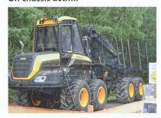
Le constructeur finlandais Ponsse a fait coup double. Il a d'abord remporté, ensemble avec son partenaire commercial d'Allemagne du Nord Wahlers Forsttechnik GmbH, un prix pour le châssis actif du Ponsse « Buffalo ». Grâce à cette structure innovante en trois éléments pour débusqueur, la cabine du véhicule reste en position horizontale quelle que soit la configuration du terrain. L'habitacle est fixé par un dispositif pendulaire à la partie frontale du châssis, équipée d'un bogie autonivellant.
