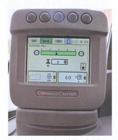
Transmission «PowerQuad Plus» de John Deere: réglage de la tolérance de chute du régime moteur sur quatre paliers à passage sous charge. Cinq niveaux sont disponibles.
