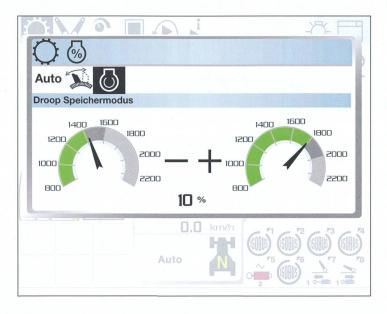
La tolérance de chute du régime moteur Claas, doté d'un accélérateur manuel à deux mémoires, est indiquée par la zone grisée, le régime maximal s'élevant à 1600 tr/min à gauche et à 2000 tr/min à droite. Elle est réglée à 10 % dans les deux cas.
