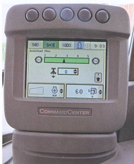
Transmission «PowerQuad Plus» de John Deere : réglage de la tolérance de chute du régime moteur sur quatre paliers à passage sous charge. Cinq niveaux sont disponibles.
