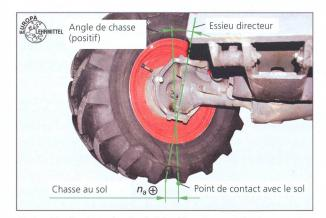
Outre l'inclinaison de pivot et le déport au sol, la chasse est une grandeur décisive qui détermine les forces de rappel agissant sur l'essieu directeur.
