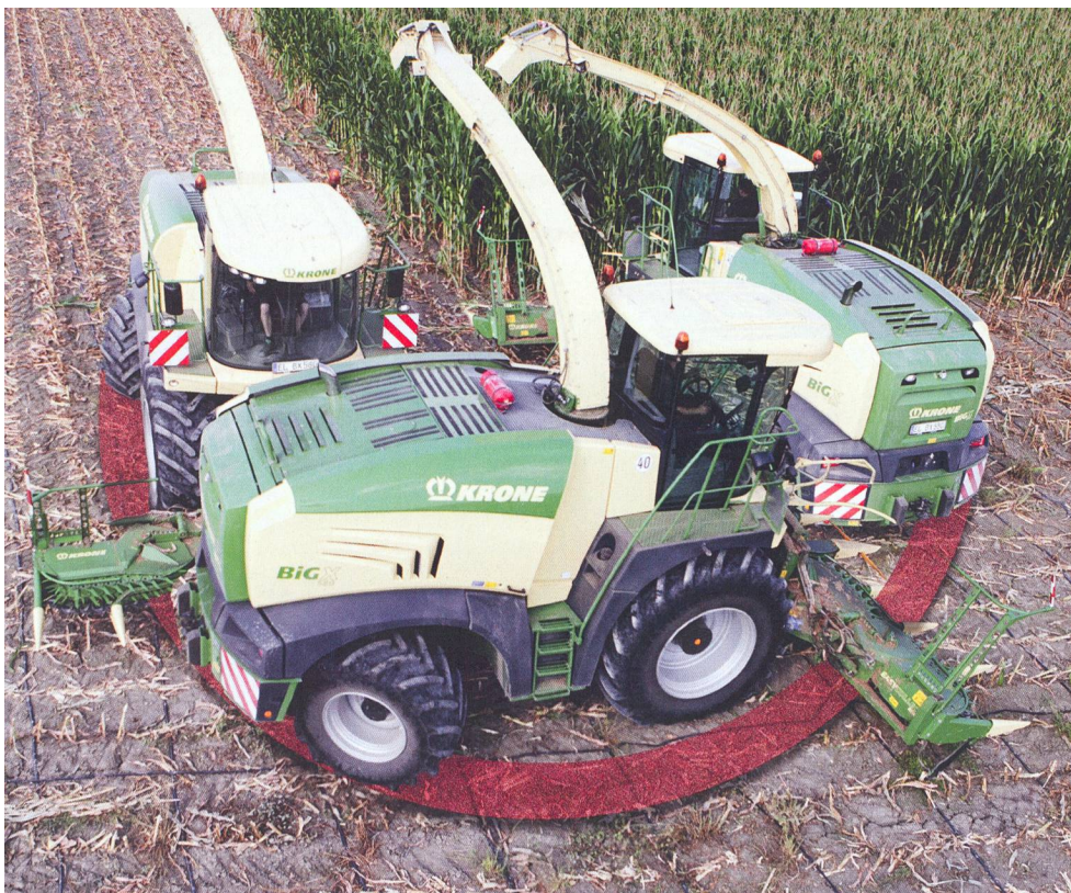
C'est la direction arrière qui confère aux ensileuses leur excellente maniabilité. Photo: Krone
