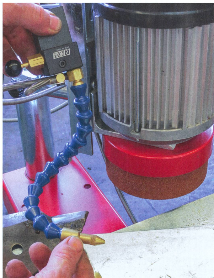
Le refroidissement, d'une grande efficacité, fait appel à un brumisateur mobile alimenté en air comprimé.
