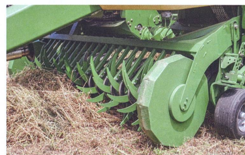
Le pick-up est précédé d'un rouleau de retenue constitué de grandes dents en acier.
