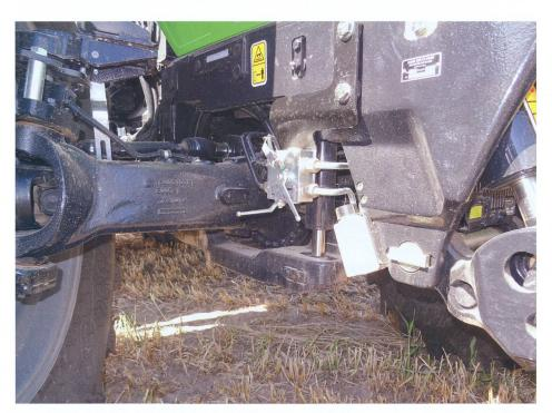
La suspension de l'essieu avant est basée sur le principe de la suspension longitudinale. Sa gestion est électronique.
