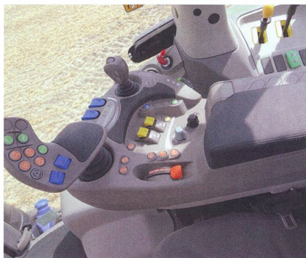
Les commandes pour la transmission sous charge simple, pour la transmission automatisée «RC-Shift» et pour la variante à variation continue.
