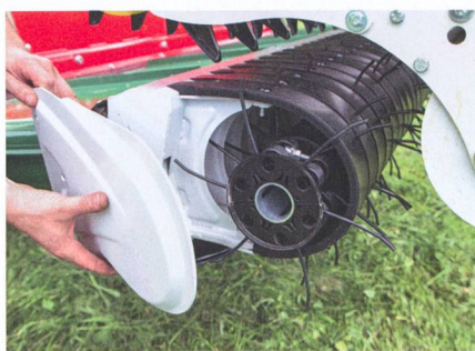
Le pick-up affiche un petit diamètre et possède six rangées de dents fixes. Les dents sont fixées sans boulons dans des demi-tubes en matériau synthétique.
