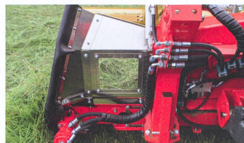
Les deux fenêtres latérales apportent une bonne visibilité du tapis depuis la cabine du tracteur.
