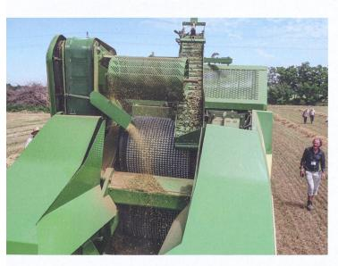
Les deux cylindres à matricer à rotation inversée constituent le cœur de la machine. Les pellets sont tamisés et transportés par des vis sans fin et des convoyeurs jusqu'à la trémie.
