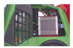
Les filtres à air et radiateurs sont installés juste derrière la cabine.
