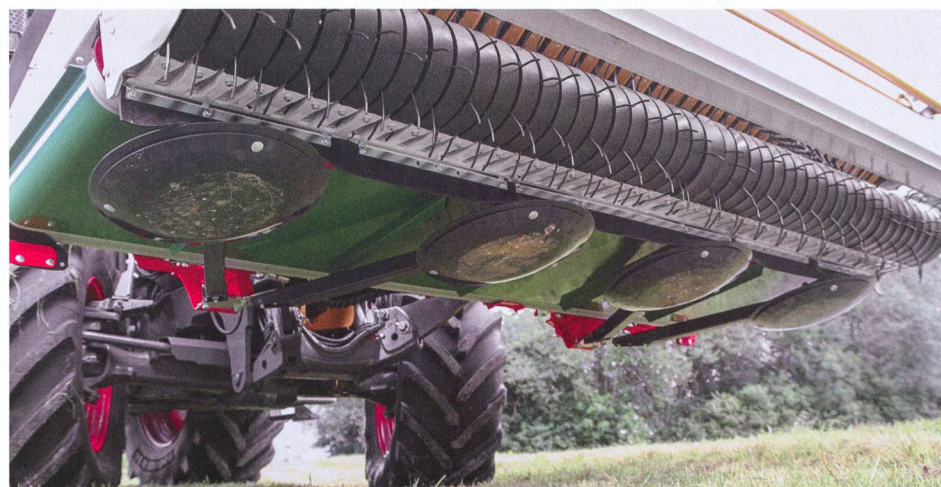
Quatre patins rotatifs définissent la hauteur de travail et assurent le suivi du sol du pick-up élastique.
