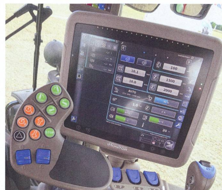
Les commandes pour la transmission sous charge simple, pour la transmission automatisée «RC-Shift» et pour la variante à variation continue.
