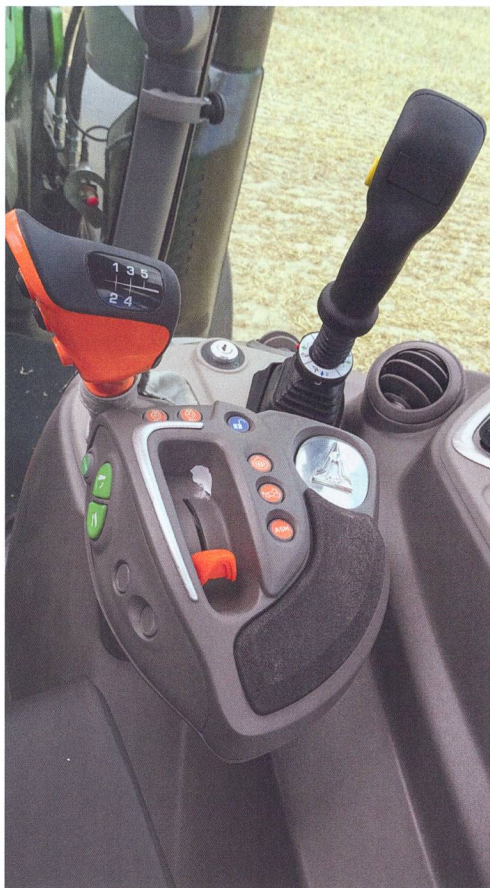
Les commandes pour la transmission sous charge simple, pour la transmission automatisée «RC-Shift» et pour la variante à variation continue.
