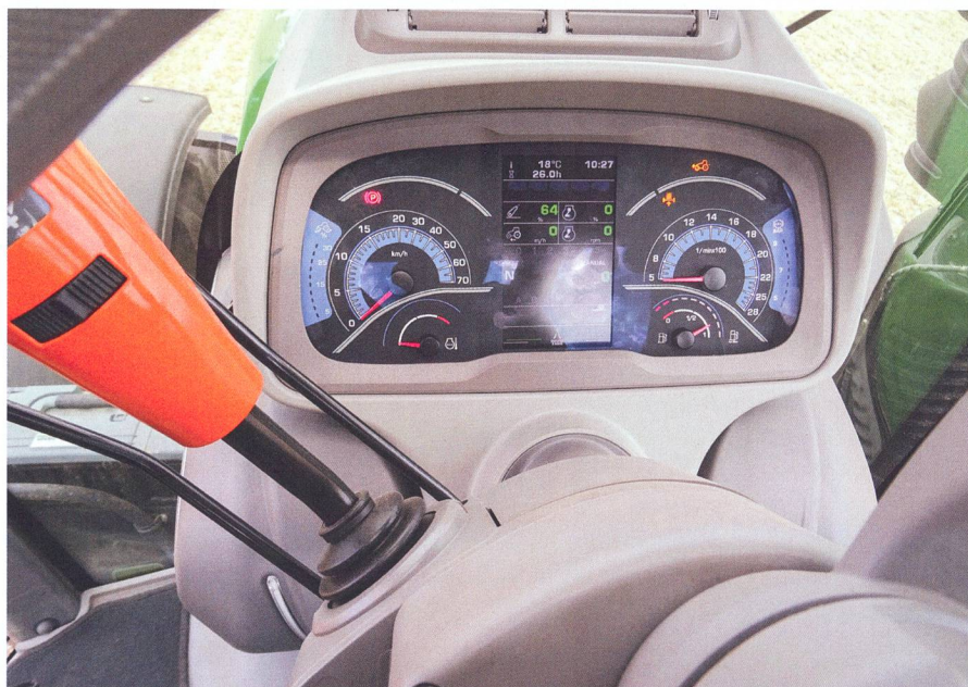
Le nouvel ordinateur «InfoCentre» bouge quand on ajuste la colonne de direction.
