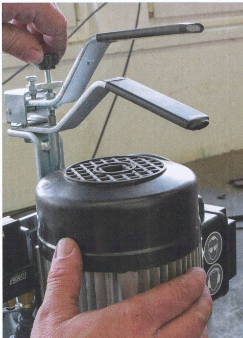
La vis à molette fait avancer la meule pour tenir compte de l'enlèvement de matière; un demi-tour tous les quatre à cinq mouvements de va-et-vient avec la meule s'avère optimal.
