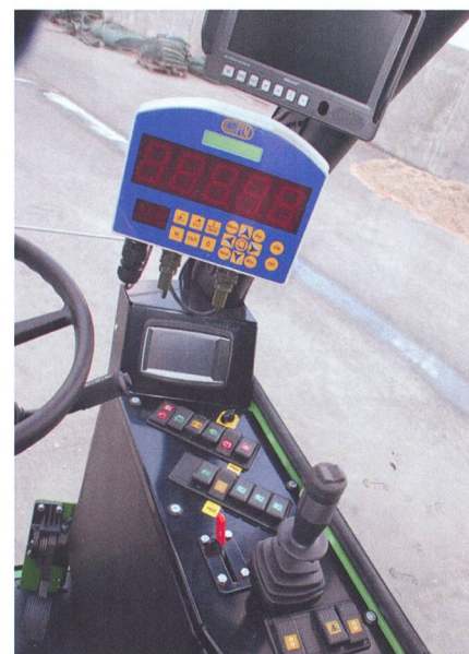
Toutes les commandes sont regroupées sur la droite du siège du chauffeur.
