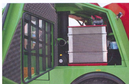
Les filtres à air et radiateurs sont installés juste derrière la cabine.
