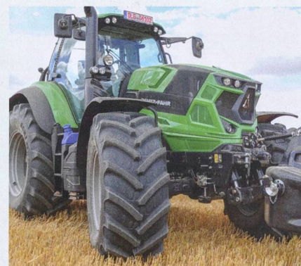
La transmission variable en continue de la série « 7 » – ici le plus gros modèle « 7250 TTV » – est conçue pour une vitesse de 60 km/h.
