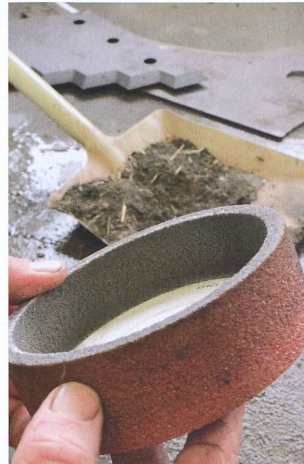
Après avoir affûté près de 20 couteaux, la meule spéciale mise au point par Andreas Moser présente peu de traces d'usure. Le contenu de la pelle à poussière à l'arrière-plan représente juste une partie du métal dur qui a été enlevé par la meule.
