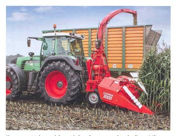
Kemper est très expérimenté dans la construction de dispositifs de récolte du maïs indépendants des rangs pour automotrices et en équipe également ses propres machines. Photo: Kemper
