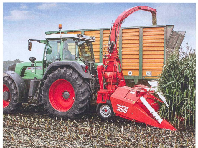
Kemper est très expérimenté dans la construction de dispositifs de récolte du maïs indépendants des rangs pour automotrices et en équipe également ses propres machines. Photo : Kemper
