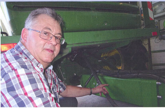
Peter Meier, le concepteur de la base de la remorque, indique l'emplacement du capteur de contrôle d'effort sur le timon.
