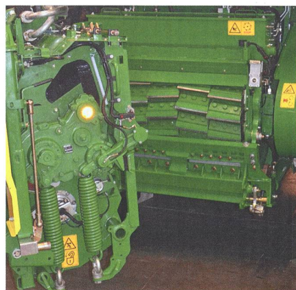
Le système John Deere « ProCut » mesure la distance entre la lame et la contre-lame par le biais d'un capteur inductif. En outre, il est possible de mesurer automatiquement l'affûtage de chaque lame. Photo: R. Hunger
