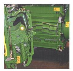
Le système John Deere «ProCut» mesure la distance entre la lame et la contre-lame par le biais d'un capteur inductif. En outre, il est possible de mesurer automatiquement l'affûtage de chaque lame. Photo: R. Hunger
