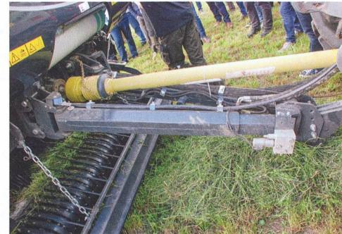
Le timon des presses équipées du système «AutoFeed Control» coulisse pour diriger le flux du fourrage de manière homogène dans la chambre de compression.
