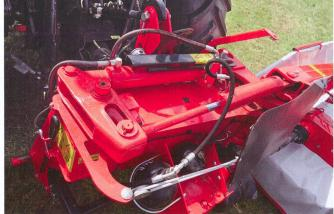
Les nouvelles faucheuses disposent de la suspension «Lift Control» qui, grâce à ce parallélogramme, sert aussi de sécurité anti-collision.
