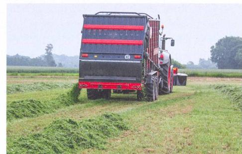
Avec leur tapis latéral escamotable, les autochargeuses «Rotex» gagnent encore en polyvalence.
