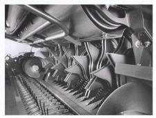
Les étoiles du rotor des presses à chambre variable « Variant 400 » forment une hélice sur 360° au lieu des 180° précédemment.
