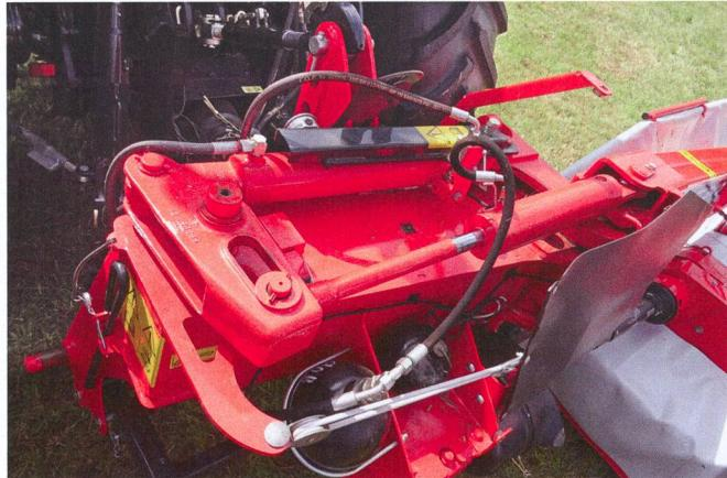
Les nouvelles faucheuses disposent de la suspension «Lift Control» qui, grâce à ce parallélogramme, sert aussi de sécurité anti-collision.
