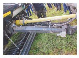
Le timon des presses équipées du système « AutoFeed Control » coulisse pour diriger le flux du fourrage de manière homogène dans la chambre de compression.
