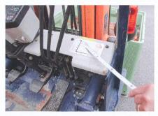
Le diagramme présent sur tous les véhicules de manutention montre clairement où sont les frontières selon le poids de la charge et le centre de gravité. Les engins modernes empêchent maintenant les manipulations qui pourraient conduire à une situation instable.
