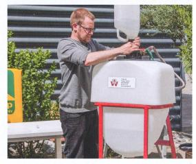
Le nouvel «easy Flow» consiste en un système fermé pour verser le produit phytosanitaire concentré dans la cuve des pulvérisateurs et garantit un rinçage des bidons sans danger.
