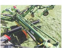
L'essieu est autosuiveur, relié par une tringle de commande avec le bâti d'attelage.
