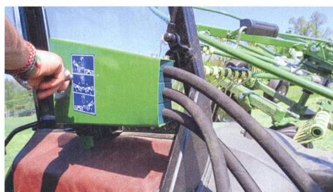
L'unité de commande du relevage des rotors est un modèle de simplicité.
