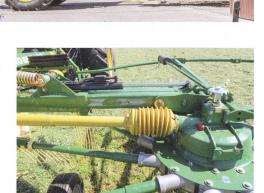
Le réglage hydraulique de la largeur de travail permet d'obtenir des andains de 80 à 160 cm.
