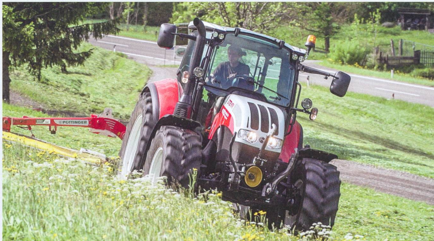
Les nouveaux « Multi » se distinguent par leur transmission automatisée, leur pont avant suspendu et un accoudoir pour les commandes.
