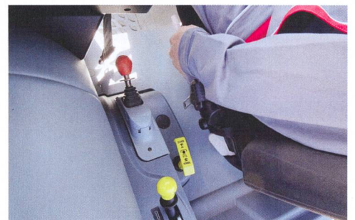
Disponible en option, un frein de stationnement mécanique et hydraulique pour une sécurité totale quelle que soit la pente.
