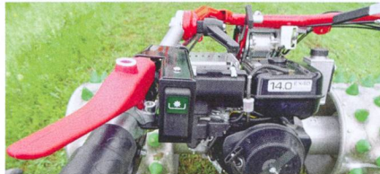
La direction peut se commuter mécaniquement entre le levier et le guidon.
