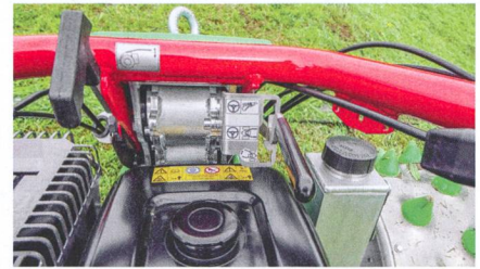
La direction peut se commuter mécaniquement entre le levier et le guidon.
