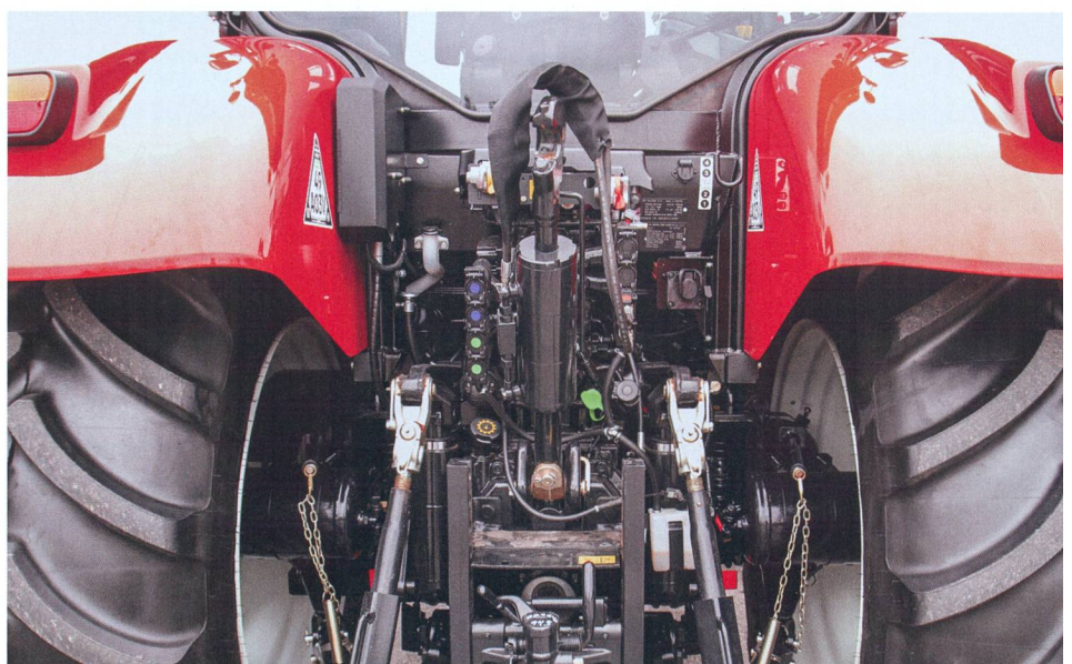
A l'arrière, les prises hydrauliques sont maintenant en couleur et réparties de part et d'autre du bras supérieur du relevage.
