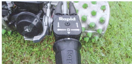
Une poignée rotative permet l'avancement en continu en marche avant et arrière.
