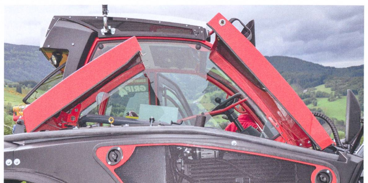
La grille placée devant les radiateurs est nettoyée automatiquement ou manuellement par une inversion de la rotation du ventilateur. La prise d'air pour le moteur est placée dans la zone la plus propre : sur le toit de la cabine.
