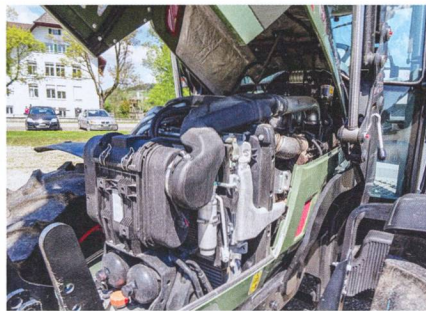
Le moteur à régulation électronique est conforme à l'étape 3b de la norme de dépollution.
