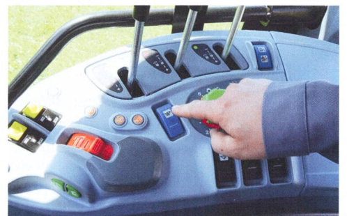
La pompe « Eco » peut être activée avec l'interrupteur à bascule de manière à ce que le débit soit déjà maximal à 1600 tr/min.
