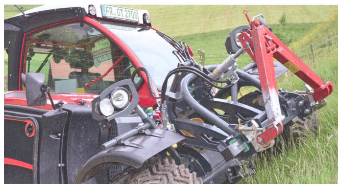
Le débattement de l'essieu avant pendulaire est impressionnant. Même dans les topographies les plus extrêmes, les quatre roues sont toujours en contact avec le sol.
