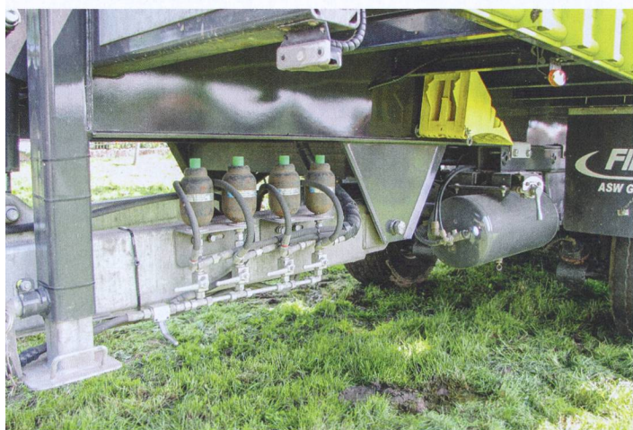
Le train de roulement tridem à pression pneumatique avec jantes en aluminium.
