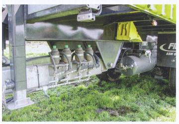
Le train de roulement tridem à pression pneumatique avec jantes en aluminium.
