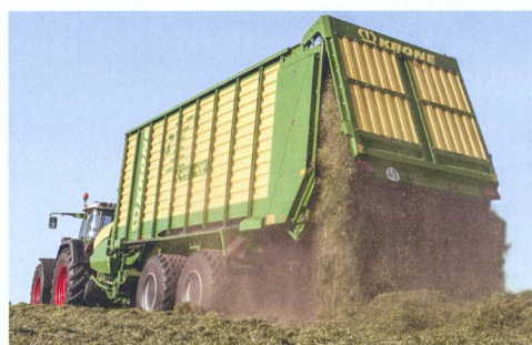
Les autochargeuses Krone sont dotées d'un double entraînement du fond mouvant et d'une forme conique pour accélérer le déchargement. Photo: Krone
