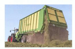
Les autochargeuses Krone sont dotées d'un double entraînement du fond mouvant et d'une forme conique pour accélérer le déchargement. Photo: Krone
