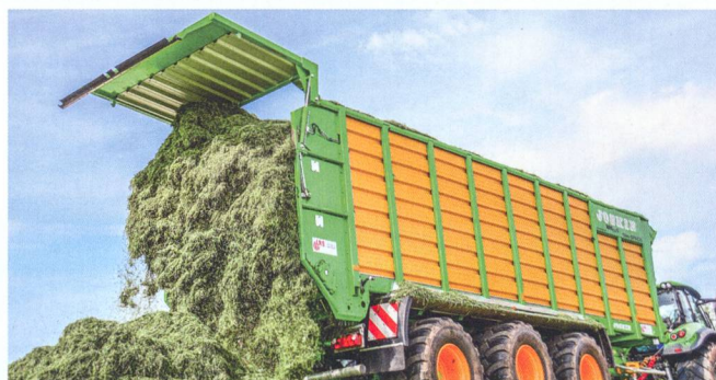
Actuellement, presque tous les modèles sont équipés de suspensions hydrauliques ou de châssis hydropneumatiques en mesure de répartir uniformément le poids sur toutes les six roues. Photo: Joskin
