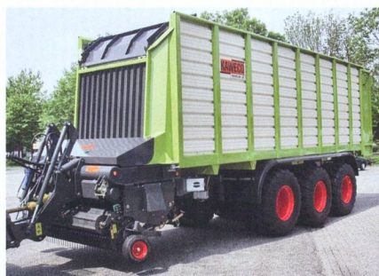
L'autochargeuse traditionnelle convient comme remorque ensileuse à coupe courte tout comme remorque de transport pour les produits hachés. L'image montre un modèle Thorium 55 de Kaweco. Photo: Kaweco
