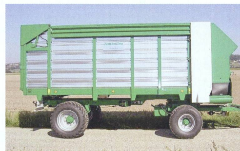
Le «Jumbolino» est un représentant bien connu des transporteurs réservés aux ensilages. La photo montre le modèle remorque à quatre roues. Photo: Gilibert
