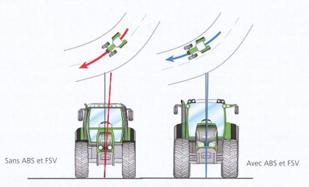
Le FSC de Fent bloque dès 20 km/h la compensation entre les côtés gauche et droit sur l'essieu avant à régulation de niveau, ce qui améliore la stabilité du véhicule. Schéma: Agco/Fendt
