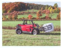
Lorsque la trajectoire de levage et d'abaissement est pratiquement verticale, il ne survient presque aucun déplacement du moment de charge dans le sens longitudinal.
