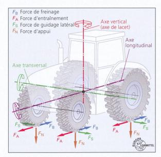
L'axe longitudinal est soumis aux forces d'entraînement, de freinage et de frottement, tandis que les forces centrifuge et de guidage latéral s'exercent sur l'axe transversal. Enfin, la charge de roue et les forces générées par les irrégularités du sol agissent dans le sens de l'axe vertical du véhicule.
