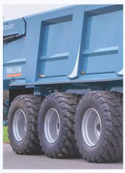
Grâce à la conception optimisée de la bande de roulement, l'empreinte sur les pneus porteurs est supérieure à celle des pneus standard malgré les grands vides de la bande de roulement.
