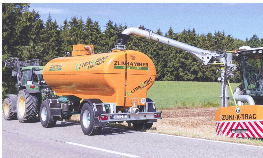
Les constructions autoporteuses en fibre de verre et sans châssis réduisent le poids à vide, mais exigent une grande stabilité. En conclusion, la quantité transportable plus élevée compense le poids économisé (env. 1000 kg / l). Photo: Zunhammer
