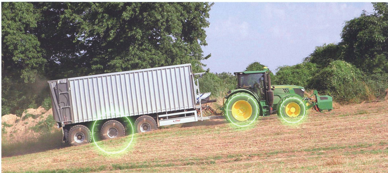
La collaboration de John Deere et Fliegl pour le développement du «sDrive» a abouti à un essieu moteur à entraînement électrique qui règle sa puissance selon l'état de chargement du tracteur. Le générateur relié à la prise de force sert de source de courant. Photo: John Deere
