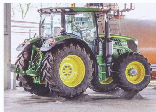
Attention accordée à la qualité du produit: 10000 heures de secouage de châssis sont une vraie torture pour un tracteur.
