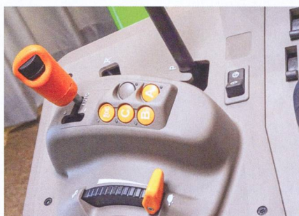
Nouvelle boîte de vitesse: la «Command-Quad Plus» permet un fonctionnement entièrement automatisé.
