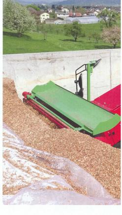
le fourrage dans la trémie. Le « Sherpa » peut prélever de l'ensilage jusqu'à une hauteur de 4 mètres. On peut obtenir, en option, un entonnoir doseur pour incorporer des minéraux et d'autres compléments en petites quantités dans le mélange.
