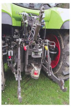
De bonne qualité, le système hydraulique dispose du circuit load sensing doté d'une pompe à pistons axiaux et d'un débit atteignant 1101/min.
