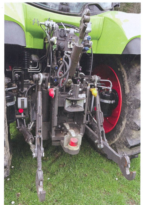
De bonne qualité, le système hydraulique dispose du circuit load sensing doté d'une pompe à pistons axiaux et d'un débit atteignant 110 l/min.
