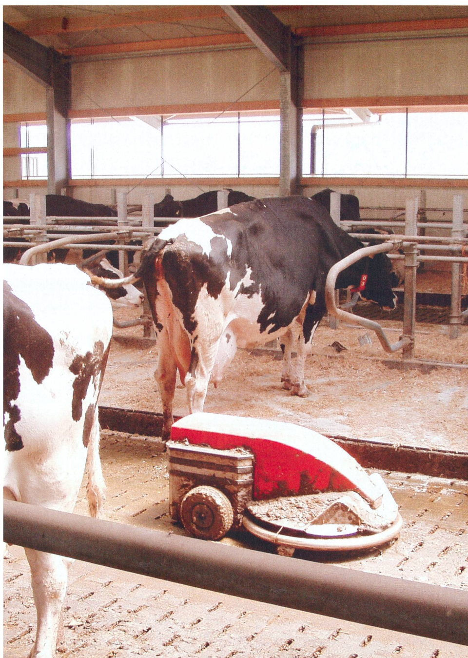
Le robot d'évacuation du fumier consiste en un robot à commande électrique programmable fonctionnant librement et nettoyant les caillebotis avec un racleur en caoutchouc rigide. Après un certain «temps de travail», il se rend de manière autonome à la station de recharge.
