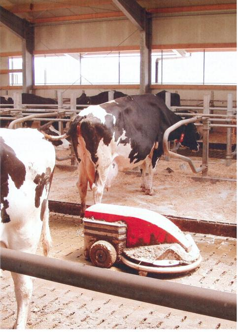
Le robot d'évacuation du fumier consiste en un robot à commande électrique programmable fonctionnant librement et nettoyant les caillebotis avec un racloir en caoutchouc rigide. Après un certain «temps de travail», il se rend de manière autonome à la station de recharge.
