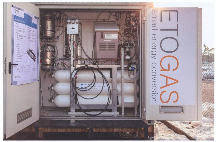
Station-service: le méthane produit est comprimé à l'aide de compresseurs et stocké dans des bombonnes.
