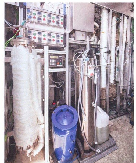
Du méthane est produit dans deux réacteurs isolés à partir d'hydrogène et de dioxyde de carbone.
