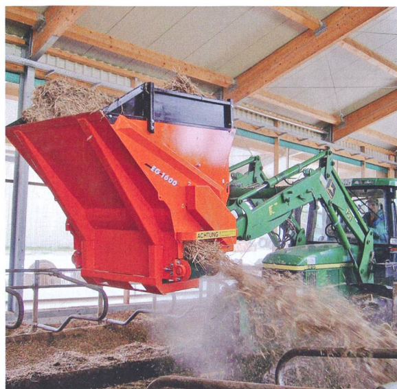
Avec attelage au chargeur frontal, l'opérateur a une bonne visibilité pour le remplissage et la décharge. Photo: Sauerburger
