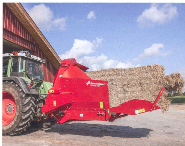
Les outils de séparation et de décharge portés peuvent traiter des balles rectangulaires, pour autant que le tracteur ait une masse correspondante. Photo : Kverneland
