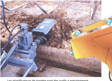
Les planificateurs de logette sont des outils à entraînement hydraulique. Ils servent à aérer et à planifier le paillage des logettes.
