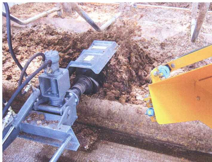
Les planificateurs de logette sont des outils à entraînement hydraulique. Ils servent à aérer et à planifier le paillage des logettes.
