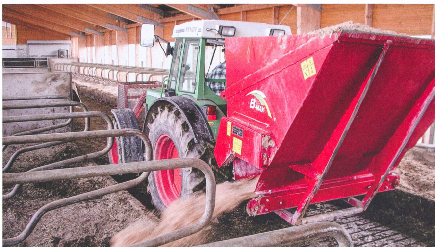
La hauteur de décharge est limitée avec l'attelage à l'hydraulique arrière, mais elle suffit pour le cas « normal ». Photo : BvL
