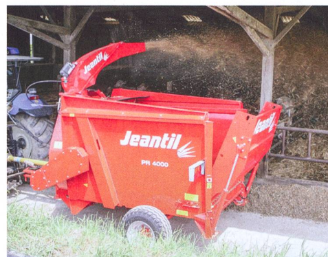
Les outils de séparation et de distribution attelés ne génèrent pas de forces de relevage sur les tracteurs, qui peuvent dès lors être de plus petite taille. Photo : Jeantil
