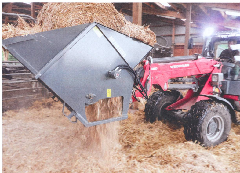
Un outil à ouverture basse sans bande convoyeuse latérale couvre les logettes avec un paillage frais et en bande. Photo: Mehrtens
