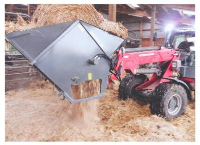
Un outil à ouverture basse sans bande convoyeuse latérale couvre les logettes avec un paillage frais et en bande. Photo: Mehrtens
