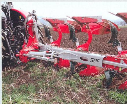
vérin sur la coulisse de réglage de l'attelage permet de positionner à tout moment la charrue dans la trace du tracteur. Sur cette charrue variable, le point de traction et la largeur du premier sillon s'adaptent automatiquement à la largeur de labour, fonction qui a nécessité des recherches très poussées lors du développement de cette gamme d'outils aratoires.
