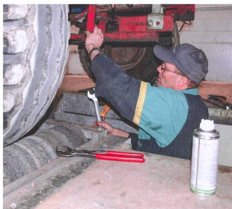
Souvent, le cylindre de frein était en butée, ce qui a pu être éliminé sur place en un tour de main.
