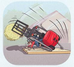
Les chariots élévateurs et agricoles doivent être équipés d'une cabine et d'un système de retenue du conducteur efficaces.
