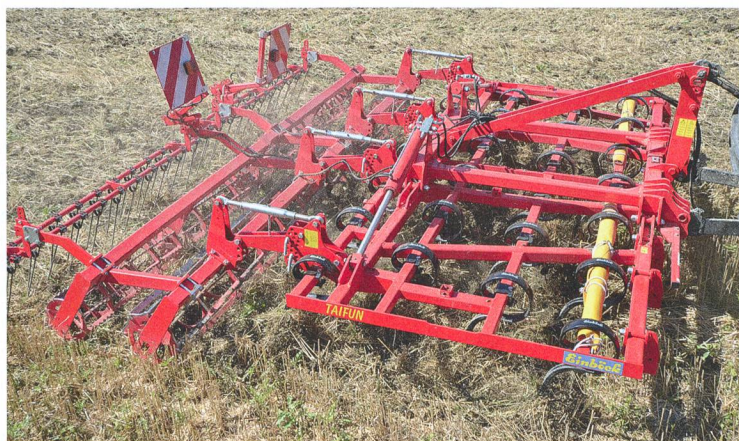
Les cultivateurs à dents souples, comme le « Taifun » d'Einböck, sont particulièrement adaptés à la lutte mécanique contre les mauvaises herbes. Le rouleau et la herse enfouissent les adventices coupées.
