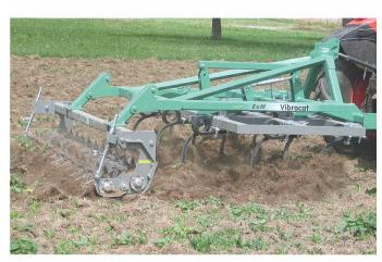
Rouleau cracker étoiles «Vibrocat» de EuM: les mauvaises herbes, comme ici les rumex, sont déposées à la surface du sol où elles sèchent.
