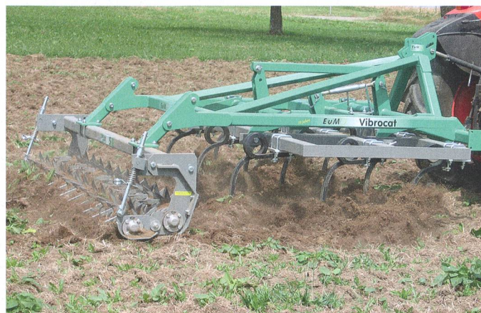
Rouleau cracker étoiles « Vibrocot » de EuM : les mauvaises herbes, comme ici les rumex, sont déposées à la surface du sol où elles sèchent.
