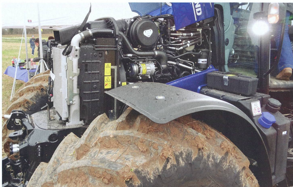
Grâce à la réduction catalytique sélective (SCR), les moteurs respectent l'étape 4, sans filtres à particules ni catalyseur d'oxydation diesel.
