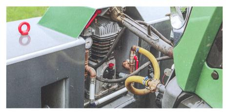
Le compresseur supplémentaire entraîné hydrauliquement remplit l'accumulateur de pression de 4001 en quelque 10 minutes à 15 bar.
