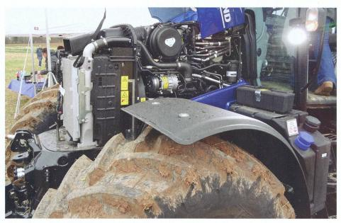
Grâce à la réduction catalytique sélective (SCR), les moteurs respectent l'étape 4, sans filtres à particules ni catalyseur d'oxydation diesel.
