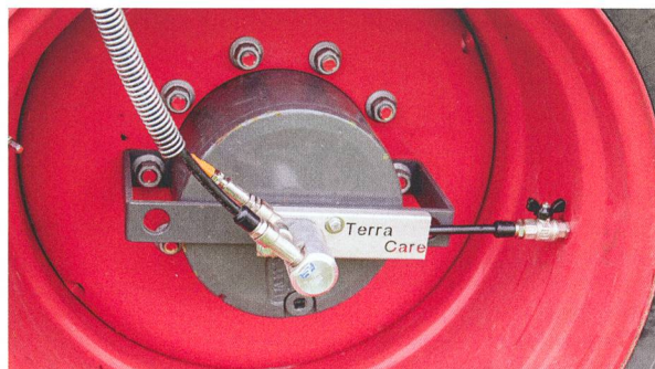
Le compresseur supplémentaire entraîné hydrauliquement remplit l'accumulateur de pression de 400 l en quelque 10 minutes à 15 bar.
