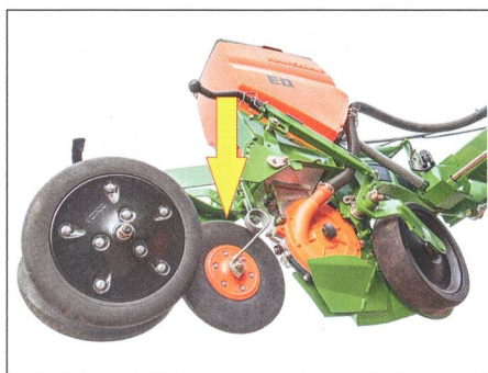
Amazone promet un fonctionnement plus silencieux de l'outil semeur «ED-Contour» grâce à un rouleau presseur supplémentaire.
