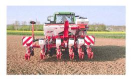
Les cadres télescopiques et les roues placées plus en avant apportent une grande flexibilité, autant pour la conduite routière que pour le choix de l'écartement optimal des rangs. Photo: Kuhn
