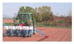
«TwinRow» est un procédé de déposition avec deux rangées individuelles adjacentes qui sont parallèles l'une à l'autre. Ainsi, l'emplacement par plante augmente considérablement comparé à une rangée individuelle. Photo: Monosem
