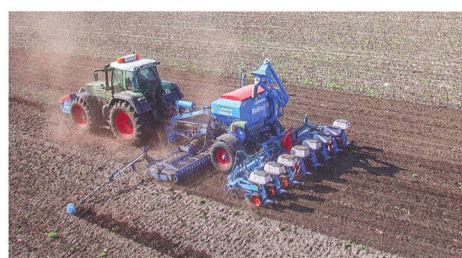
Une tendance pour la technique grandes surfaces: le châssis avec outil à travailler le sol devient un «véhicule porteur» pour la technique de semis monograin (photo) ou pour la technique traditionnelle de semis de céréales.
