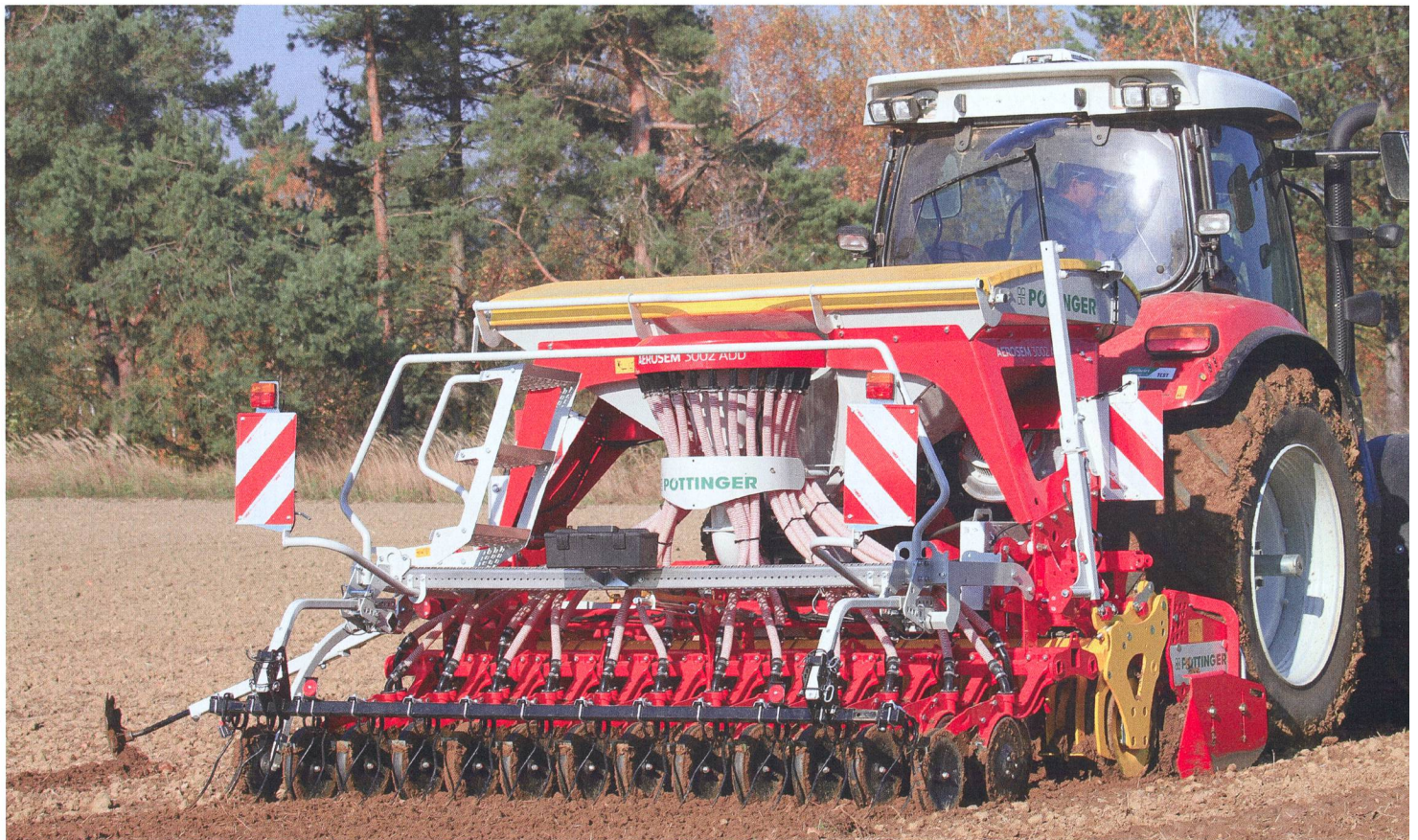
Pöttinger: herse rotative « Lion 303.12 » pour les tracteurs jusqu'à 180 ch, largeur de travail de 3 m, 12 rotors. Rouleau prisme de 500 mm de diamètre. Semoir « Aerosem 3002 ADD », largeur de travail de 3 m, 24 socs à doubles disques, trémie de 1250 l de série, jusqu'à 1850 l en option.
