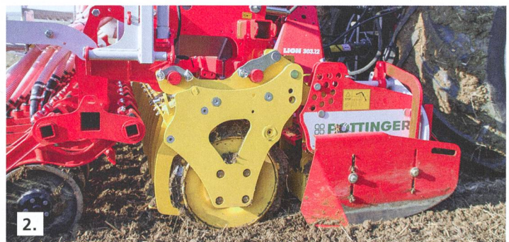
1. La roue distributrice est simple d'accès et se change sans outil.
