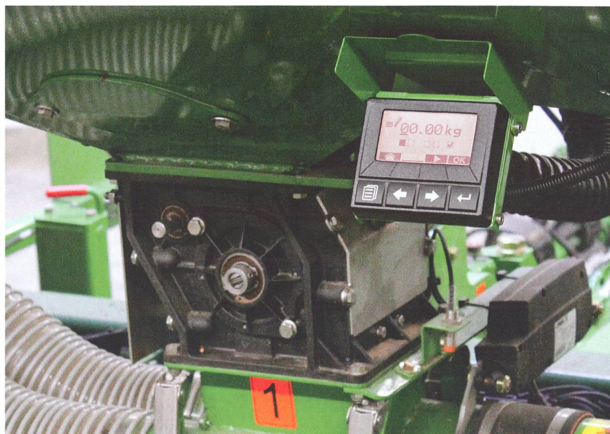
Le « Twin Terminal 3.0 » d'Amazone permet la commande et la saisie des données de calibrage directement sur la machine.
