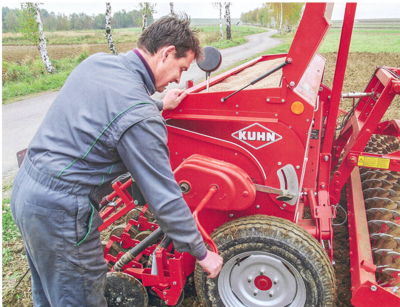
Malgré les nouvelles possibilités techniques, l'étalonnage du débit va continuer à être pratiqué sur la plupart des semoirs. Photo : Johannes Paar
