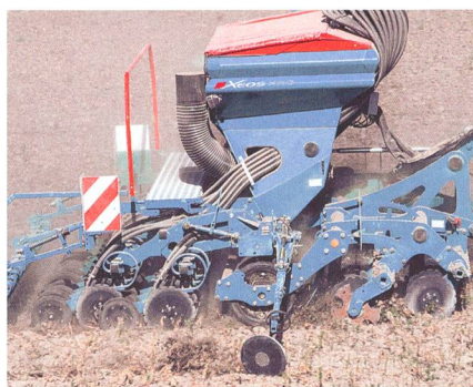
Le semis sous litière en combinaison avec un déchaumeur à disques peut aussi être effectué avec une tête d'attelage à trois points. Les machines à tirer ne sont pas obligatoires.
