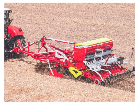
Des constructions en mode tiré – ici sur la base d'un cultivateur – permettent une plus grande distance entre chaque élément de travail.
