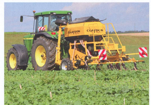
Lorsque le semis en sillons ou en bandes s'effectue sans travailler le sol, l'intervention dans celui-ci est limitée au dépôt des semences.
