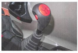
La transmission «PowerShuttle», optionnel, est assortie d'un bouton d'embrayage sur le levier de vitesses, permettant de changer de rapports sans toucher la pédale d'embrayage.
