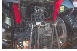
Un circuit hydraulique ouvert est monté de série pour alimenter les distributeurs et le relevage. Il est doté d'une pompe à engrenages débitant 581/min. Une pompe tandem délivrant 1001/min (58 et 421/min) est proposée en option.
