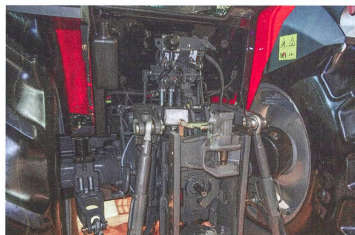
Un circuit hydraulique ouvert est monté de série pour alimenter les distributeurs et le relevage. Il est doté d'une pompe à engrenages débitant 58 l/min. Une pompe tandem délivrant 100 l/min (58 et 42 l/min) est proposée en option.
