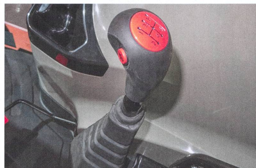
La transmission «PowerShuttle», optionnelle, est assortie d'un bouton d'embrayage sur le levier de vitesses, permettant de changer de rapports sans toucher la pédale d'embrayage.
