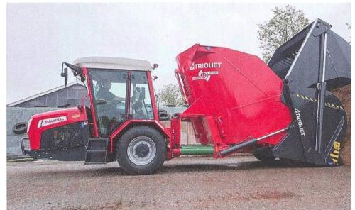
canique, avec passage de rapports sous charge et inverseur électrohydraulique. La distribution par tapis roulant horizontal peut se faire à gauche ou à droite.
