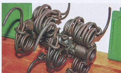
La forme des griffes de motoculteur selon le système de Meyenburg est inchangée jusqu'à ce jour.
